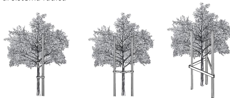
Instalación de tutores
